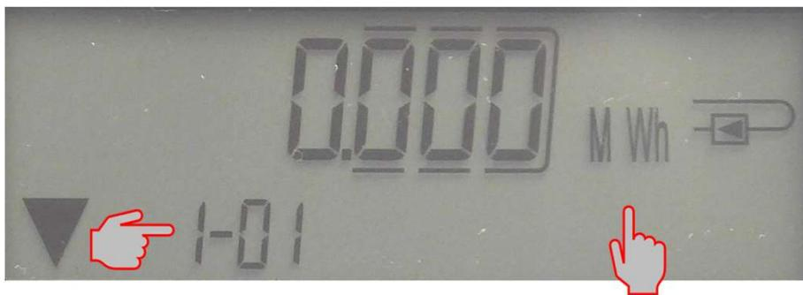
Mit einem zweiten Druck auf den Bedienknopf aktivieren Sie den Display-Test, der abwechselnd alle LCD-Elemente an- und wieder abschaltet:
