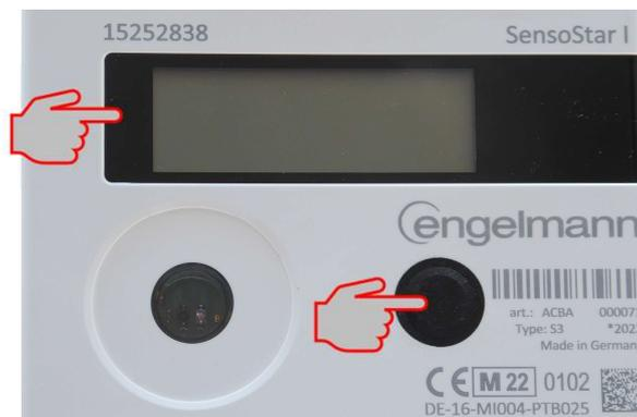
Um Batteriestrom zu sparen, schaltet das Gerät - nach 2 Minuten ohne Betätigung der Taste - das Display ab.
